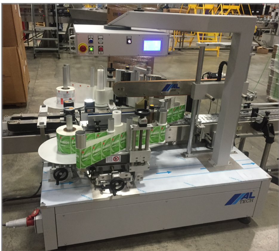
ALline E con 2 applicatori di etichette ALritma
