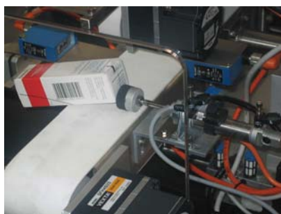
Contrôle étiquetage et expulseur
